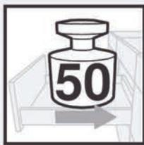
Ящики в корпусах > 900 мм и ящики с высоким фасадом для тяжелого содержания необходимо оснащать направляющими на 50 кг.
