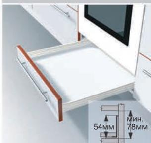
В основной комплект входят 2 одностенные цагги высотой 54 мм, 2 направляющие частичного выдвижения, 2 замка (крепления фасада) ZSF.1510.
