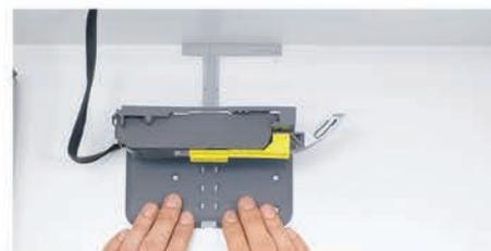
3. Задвиньте механизм SERVO-DRIVE
