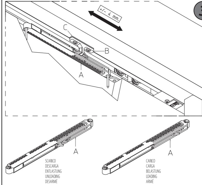
\*Installato il pannello, portarlo in battuta in chiusura e regolare, se necessario, la staffa "B" allentando le viti "B1". Verifica finale: aprire la porta e scaricare il sistema di chiusura "A". Chiudere la porta verificando il corretto aggancio tra "A" e "B".
